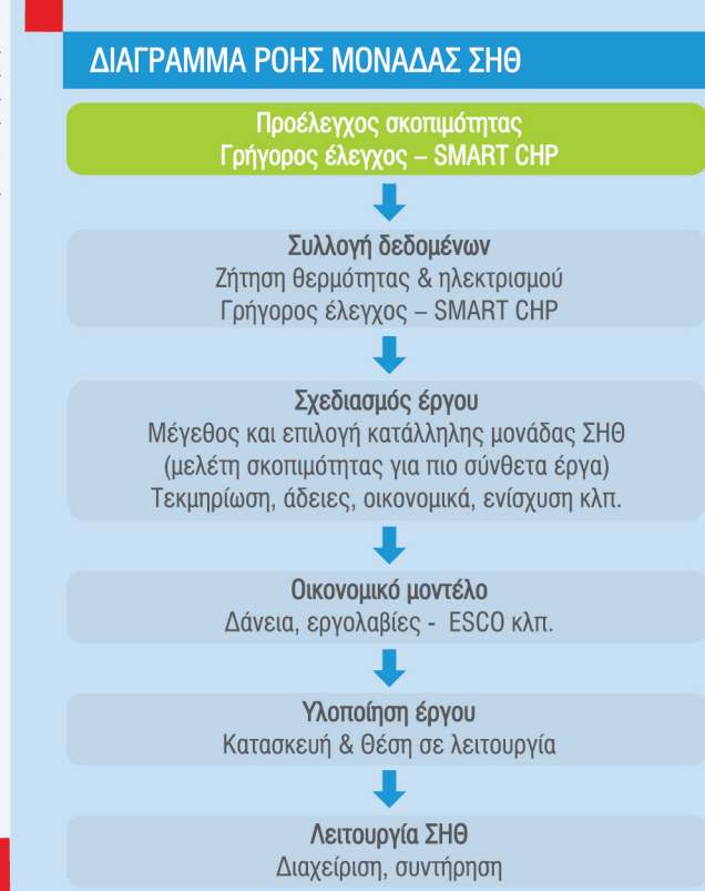
Σχήμα 3: Διάγραμμα ροής με τα απαραίτητα βήματα για πετυχημένη εγκατάσταση και προμήθεια μονάδας ΣΗΘ.
